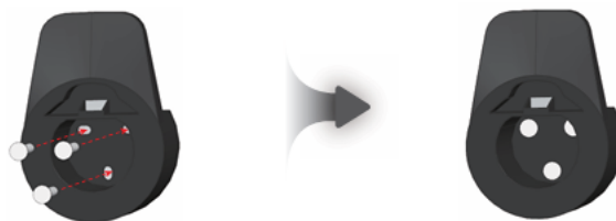
Obrázek 4.4: Instalační schéma držáku konektorů (montáž na stěnu)
