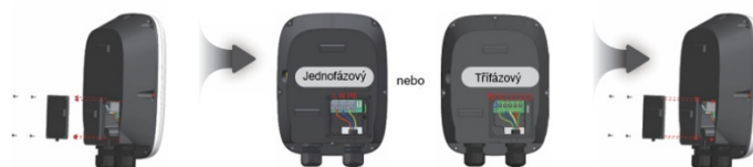
Obrázek 4.11: Kroky připojení napájecího kabelu
