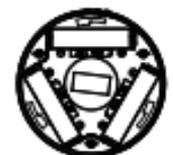
3. Fermez le couvercle de la trappe en le tournant dans le sens des aiguilles d'une montre, conformément au marquage.
